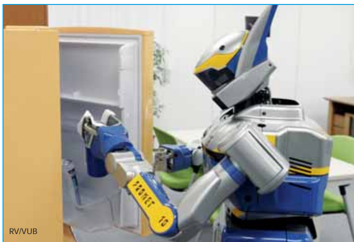
De HRP-2 Promet in actie. Een blikje uit de koelkast halen, lukt al aardig.
