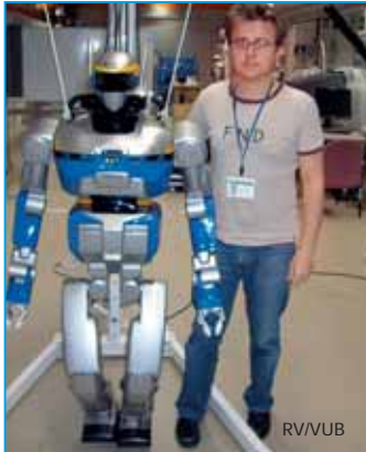
Dr. ir. Björn Verrelst en drs. Bram Vanderborght (rechts) in het gezelschap van de HRP-2 Promet, de humanoïde robot die ze dynamisch over obstakels leerden stappen.
