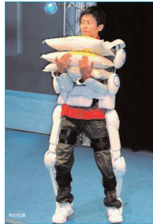
Ce robot harnais permet de renforcer la force portante chez l'homme.
