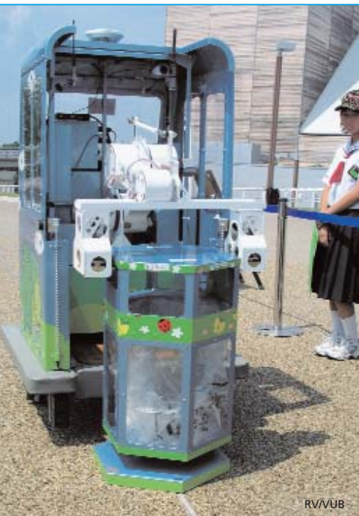
Un robot de Fuji Heavy Industries en train de remplacer une poubelle pleine par une vide.
